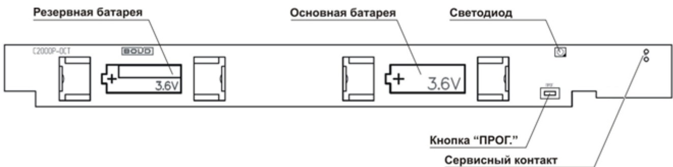
Рисунок 2.3 Расположение элементов на плате аппаратной версии 2.0
