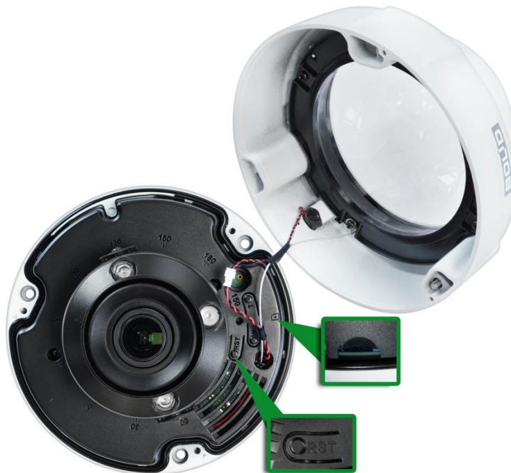
Рисунок 4.2 – Расположение кнопки аппаратного сброса и слота для карты памяти
