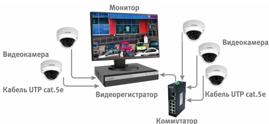
Рисунок 6.4 – Схема подключения видеокamеры к видеорегистратору
