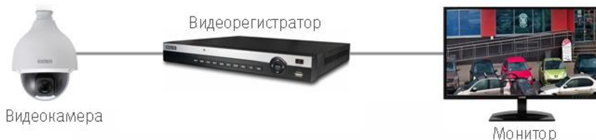
Рисунок 6.2 – Схема подключения видеокамеры
