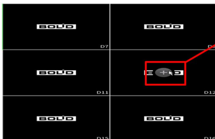
Рисунок 10.1 – Добавление в режиме просмотра
